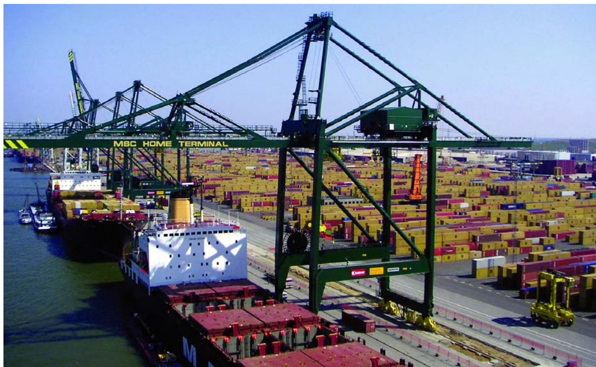
Краны STS (с берега на корабль) в Антверпене с системой энергоподвода с использованием гибких кабель-каналов для передачи данных и электроснабжения от столетних и главных токоприёмных роликов
