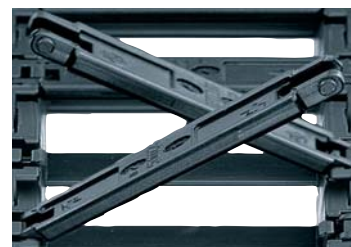
Откидной механизм, с выбором стороны откидывания - влево или вправо.
